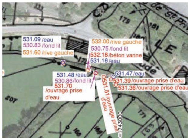
Figure 15 : Relevé topographique de l'amont du béal effectué par Michel Leurent<sup>54</sup>.
